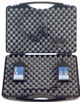
Abbildung 11.1: Komplettkoffer mit Kopfhörer und Körperschallsonde
